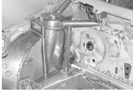
**5.4.- BARRA TRANSVERSAL.-** La barra transversal en el arco principal de la jaula, debe respetar el diseño de la Fig. N° 1, o estar por debajo del nivel de la sentadera de las butacas, si se trata de una barra recta y si está en la parte superior deberá estar a la altura de los omóplatos.
