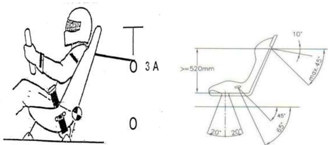
La Fig. 1 y el punto 3A, ilustra a qué altura deberá estar la barra transversal del arco principal de la jaula, para la sujeción de los cinturones.
