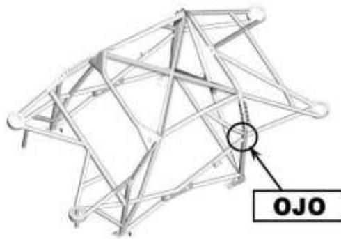
**5.3.- ANCLAJE.-** Los puntos de anclaje para las bases parantes y apoyos o tensores, deberán ser hechos sobre refuerzos de por lo menos del doble del área del tubo utilizado y tiene que estar soldado a la estructura.
